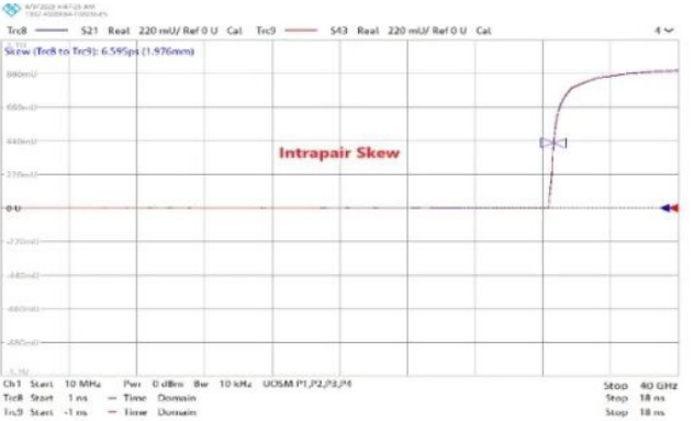
图5：40 GHz PCB线路的对内时延差测试结果
