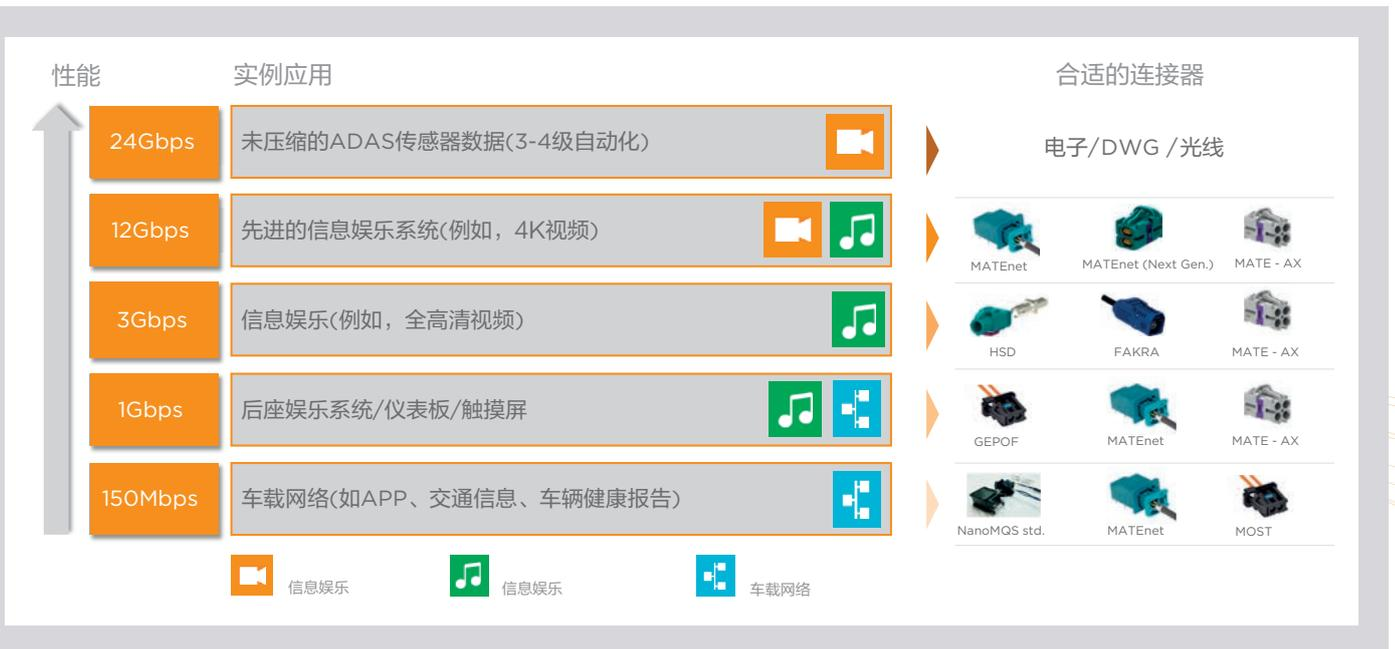
图 5: 连接器性能和潜力
