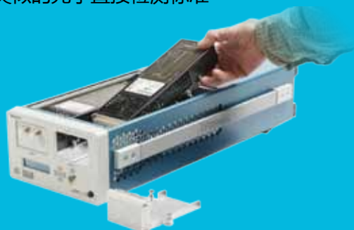
将 TSO8C18 模块插入 TSO820 主机
