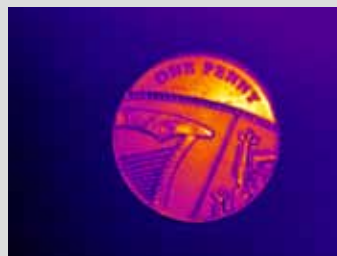
图 6. 这是使用 TiX580 热像仪搭配标准镜头拍摄到的 1 便士硬币的图像，它的直径大约为 20.3 mm。
