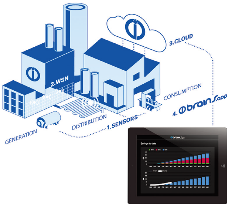
图3. 推动实现变革——软件分析，例如来自IntelliSense.io的Brains.App软件，利用工业无线传感器网络中的数据来简化工厂运营，并优化产出和提高安全性
