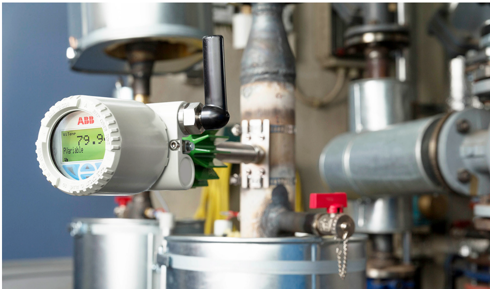
图1. 传感器无处不在。通过能量采集系统供电的低功耗无线传感器节点(例如这个来自ABB、由采集的热能驱动的无线温度传感器)可以放置在适当位置,以获得更多工业环境数据
