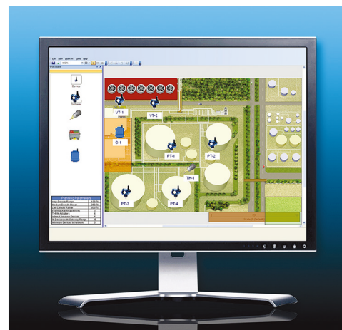
图2. 网络可视性——通过网络管理软件可查看与无线网络健康状况相关的重要信息,例如Emerson Process Management的这款SNAP-ON软件实用工具
