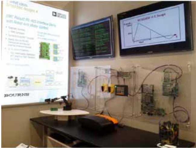
图3. 带电子护栏能源机的RS-485三节点网络框图演示
