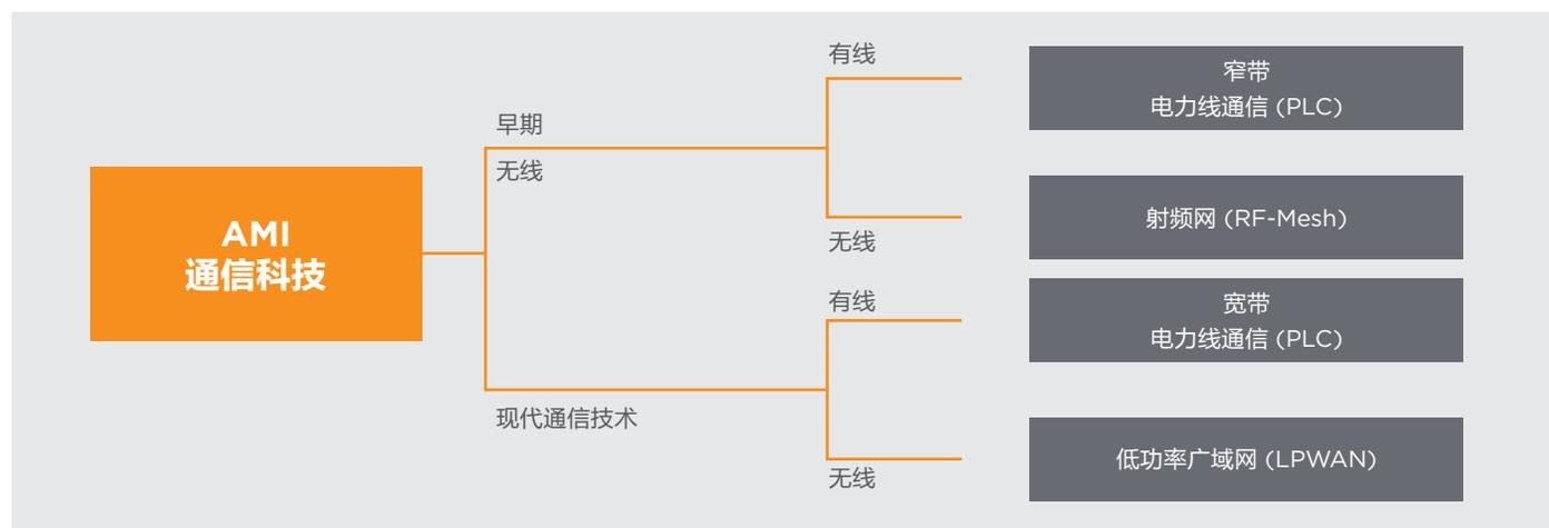
早期的 AMI 以窄带电力线通信 (PLC) 和射频网为主要通信技术，推动 AMI 和智能电表的应用。随着通信技术的进步，宽带电力线通信 (PLC) 和低功率广域网 (LPWAN) 等新技术已成为发展趋势。正如我们将在下文中介绍的，不同地区可能青睐不同的技术，所以在设计之前了解市场偏好很有必要。
